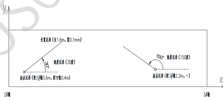
图 D.1 斜裂缝方向记录示意图
